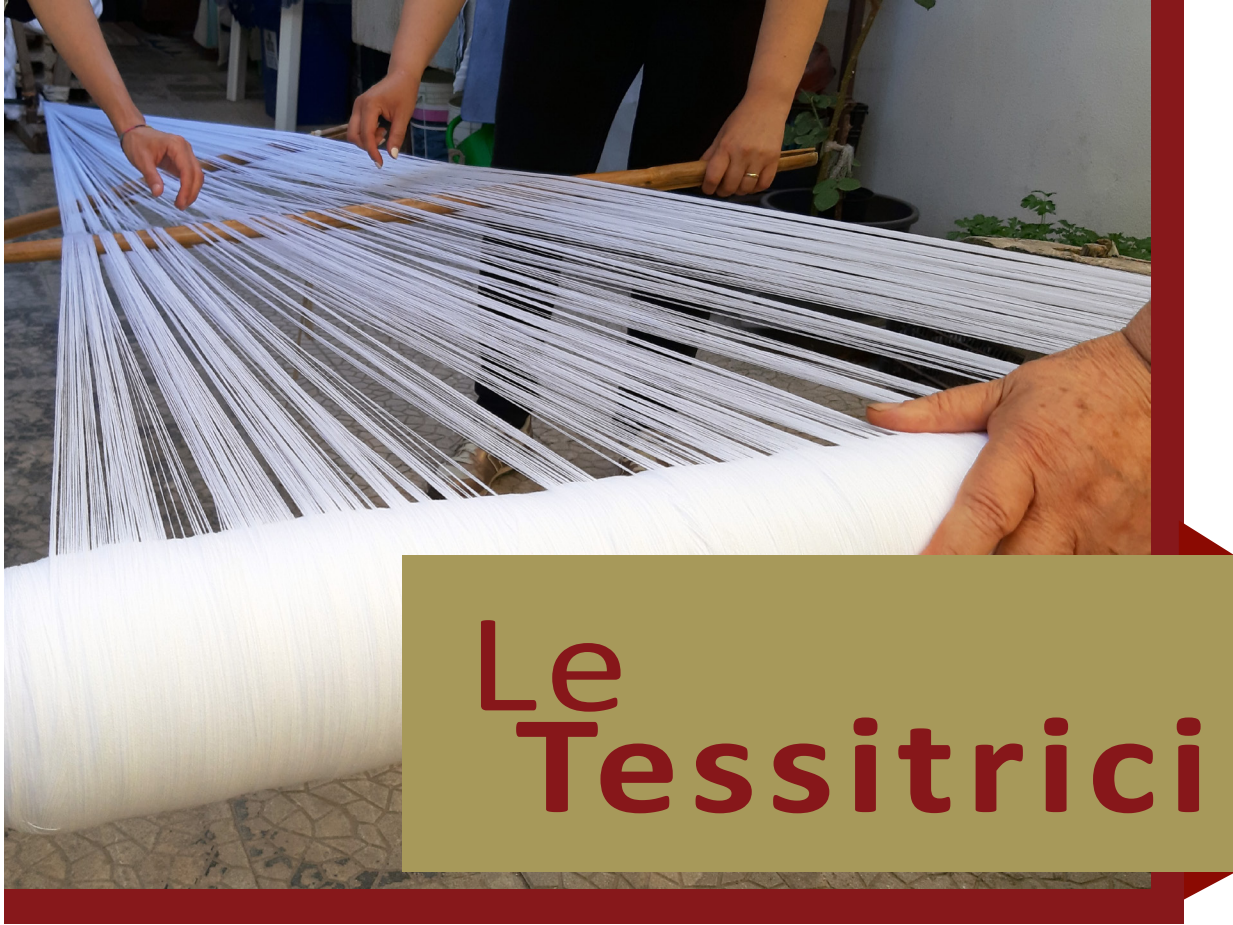
Raccolta, pettinatura e distensione dei fili di ordito sul subbio posteriore con la tessitrice Pina Specchia
