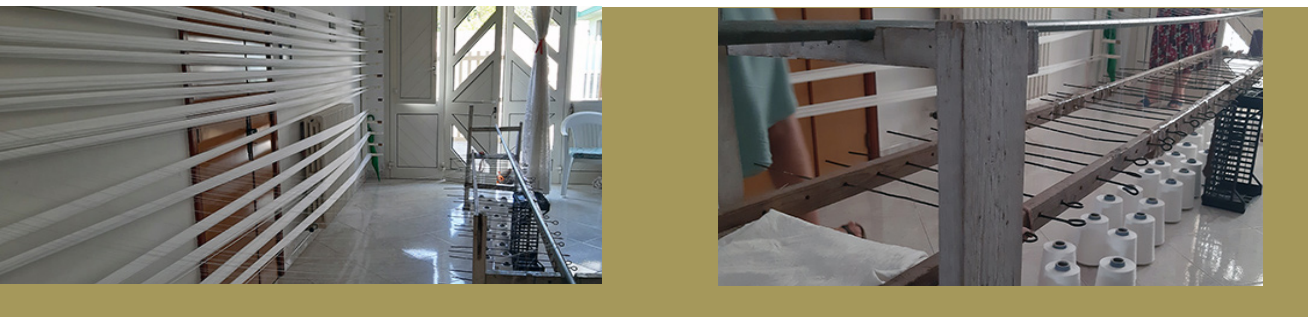
Preparazione dell'ordito presso l'abitazione della Tessitrice Pina Specchia
