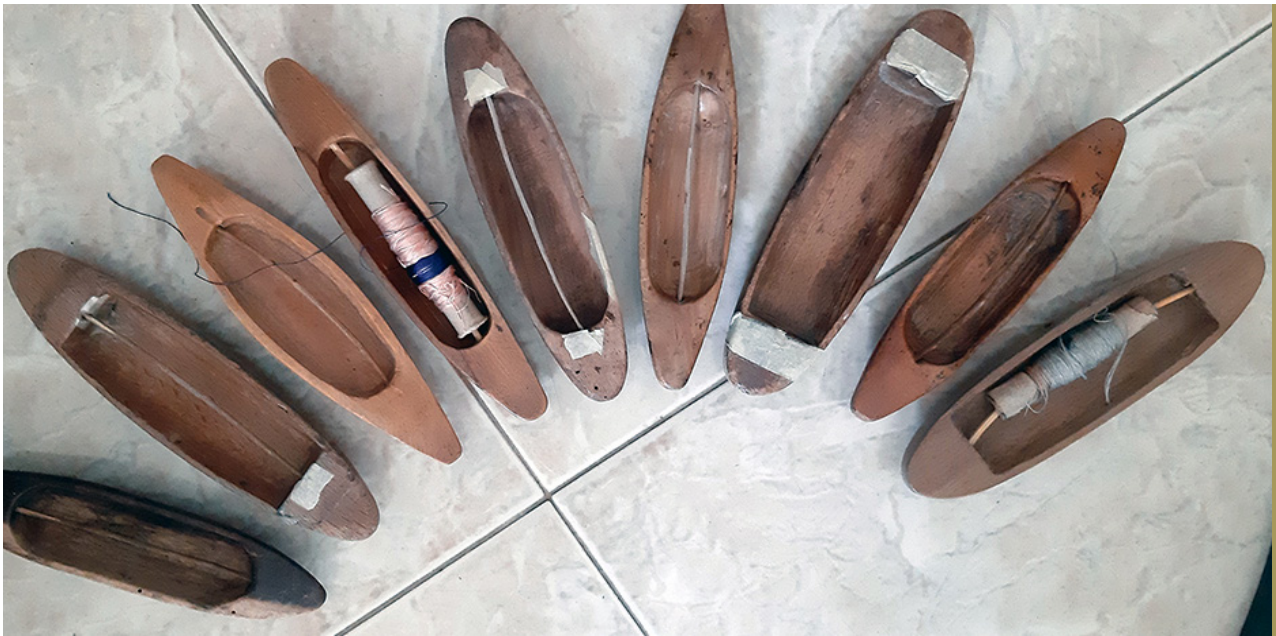
Navette, saitte, sciuscitte, spole in legno d'ulivo e di limone
